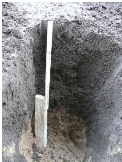
Foto 7; Probenahme E04 Mutterboden und E05 Sandschüttung aus der Böschung (siehe Foto 1)
